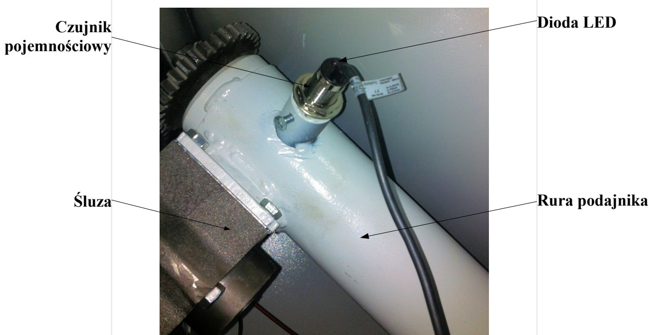
Rys nr 12. Umieszczenie pojemnościowego czujnika zbliżeniowego
