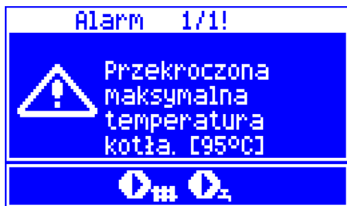
Rys. 39 Widok alarmu przegrzania kotła.
