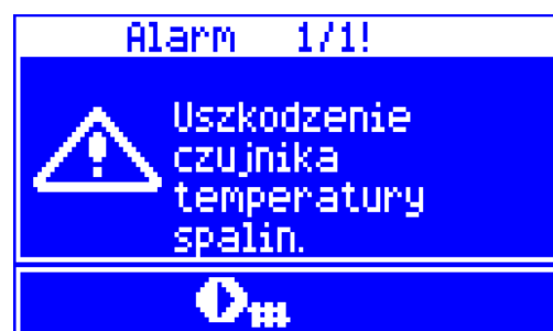
Rys. 38 Widok alarmu uszkodzenia czujnika spalin
