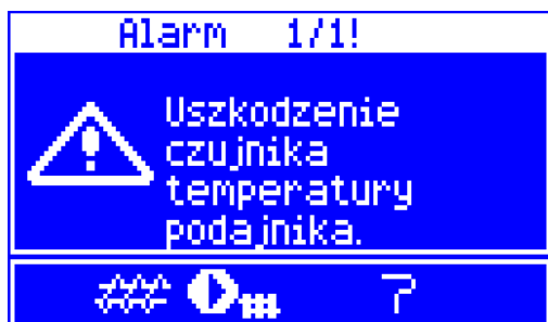
Rys. 41 Widok alarmu „uszkodzenie czujnika temperatury podajnika”.
