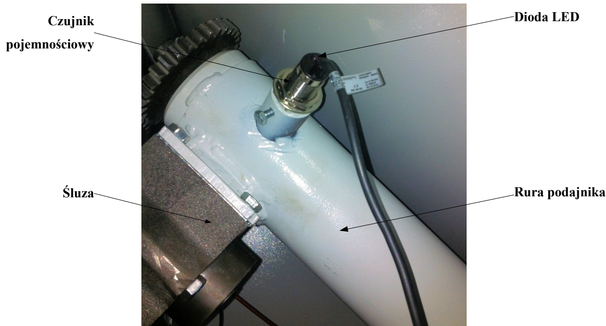
Rys nr 16. Umieszczenie pojemnościowego czujnika zblizeniowego
