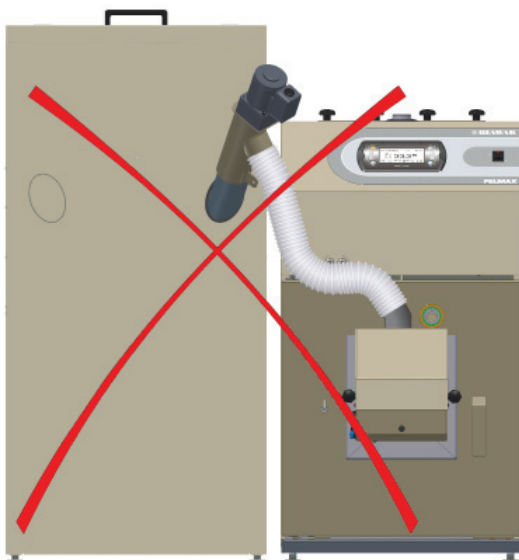
Fig. 5. Tuyau du distributeur mal raccordé.
