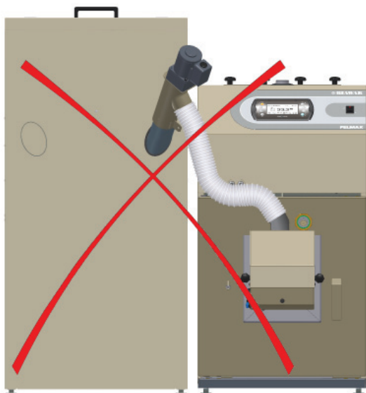
Rys. 5 Nie prawidłowe podłączenie rury karbowanej podajnika
